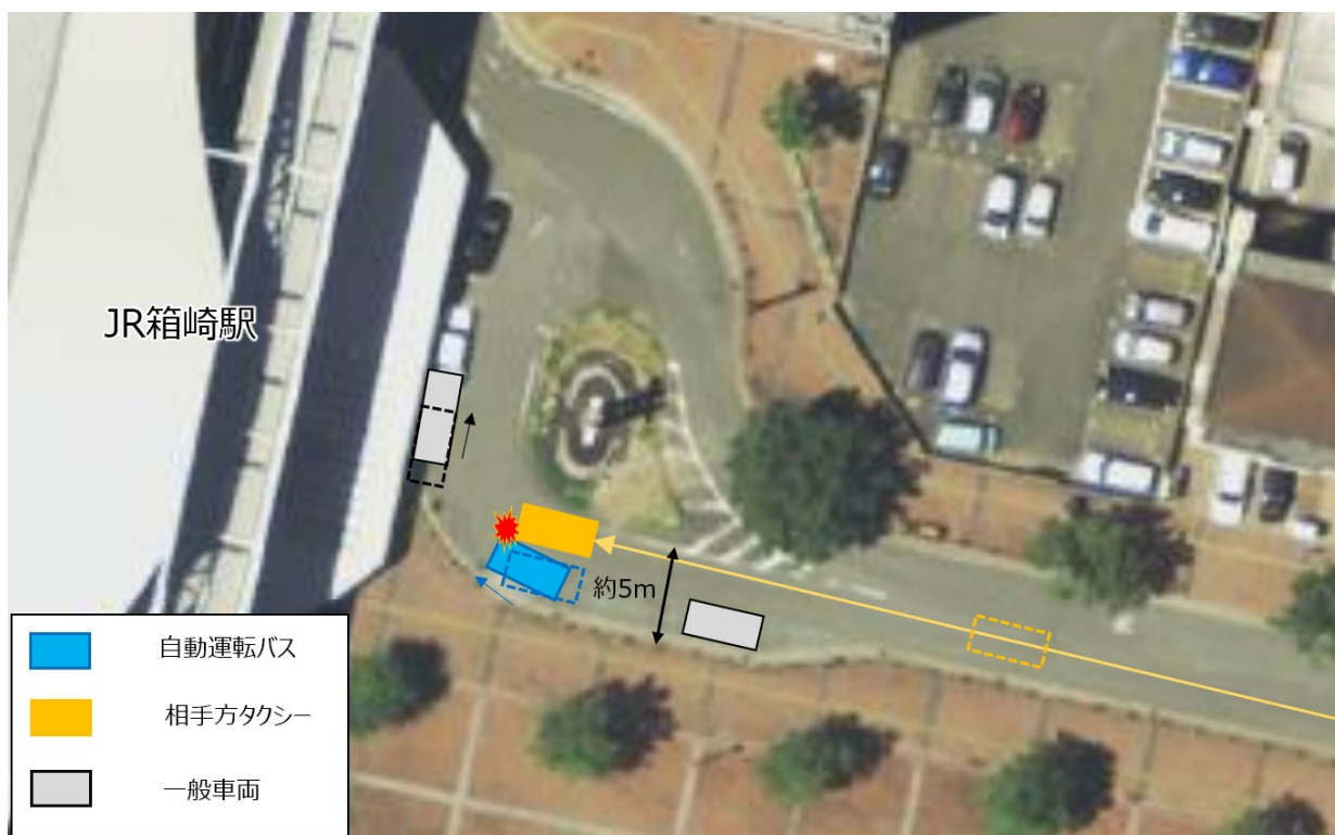
図 2 事故発生状況
